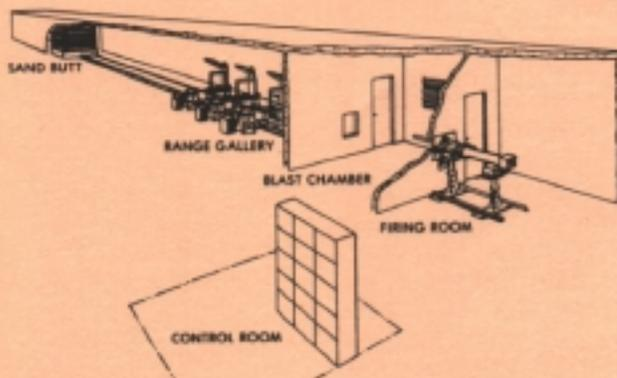
**SCHEMATIC OF THE FREE FLIGHT AERODYNAMIC RANGE**
