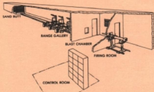
**SCHEMATIC OF THE FREE FLIGHT AERODYNAMIC RANGE**
